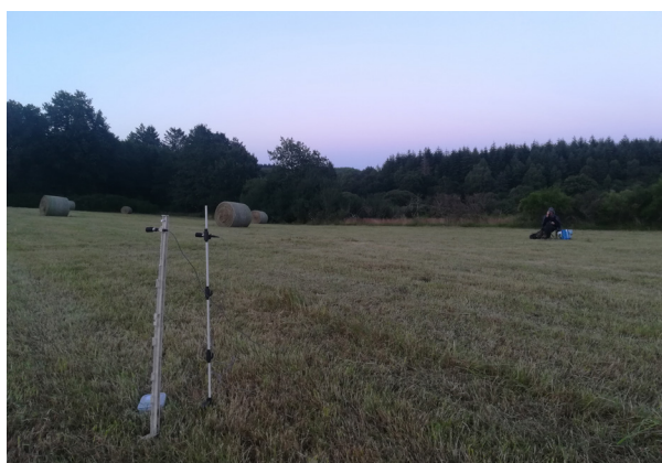
Figure 4. Stations d'écoute (centre de prairie à gauche, lisière à droite) de comparaison actif vs passif sur une prairie après fauche. Les deux microphones, au sommet de piquets, sont reliés pour l'un à l'enregistreur automatique Passive Recorder en fonction toute la nuit, et pour l'autre au détecteur manuel Active Recorder manipulé par l'observateur (distant de 20 mètres pour ne pas générer de bruits parasites) durant les 3 premières heures de la nuit.
