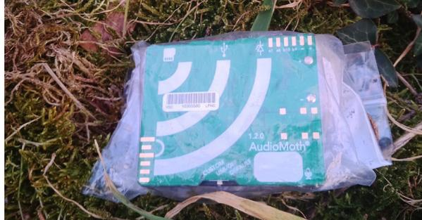
Détecteur enregistreur AudioMoth 1.2.0, avec microphone incorporé, disposé lors des enregistrements au pied du mur latéral de l'observatoire (voir en bas à droite de la photo p. 83).
