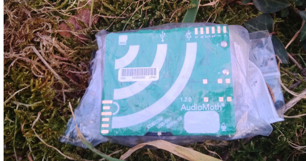
Détecteur enregistreur AudioMoth 1.2.0, avec microcophone incorporé, disposé lors des enregistrements au pied du mur latéral de l'observatoire (voir en bas à droite de la photo p. 83).
