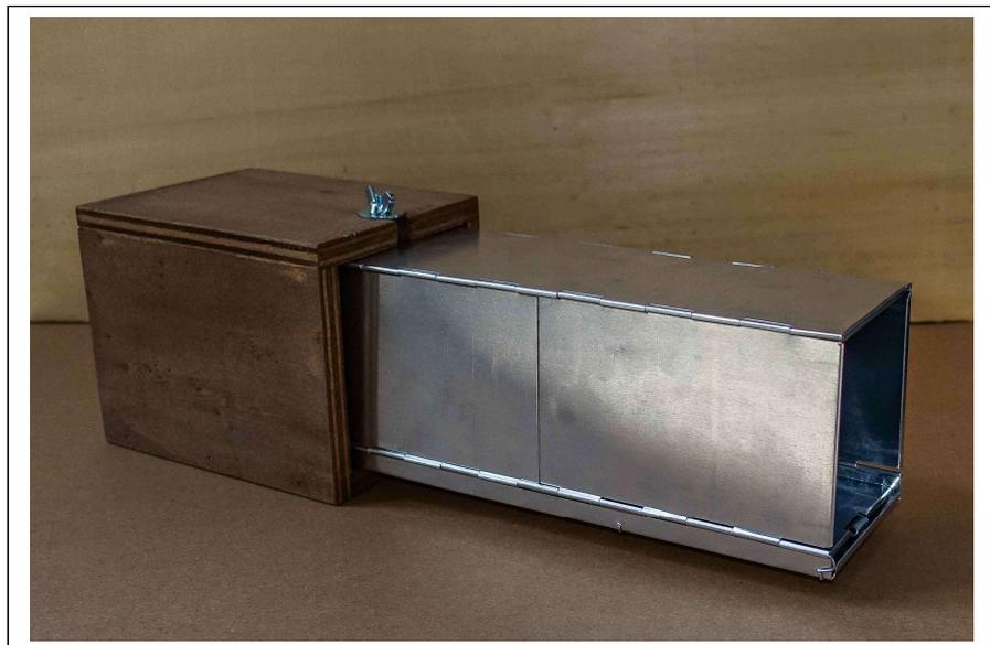
*Lorsqu'une bête est capturée (porte frontale fermée), desserrer l'écrou papillon et séparer les deux parties au-dessus d'un seau ou dans un sac pour récupérer l'animal.*
